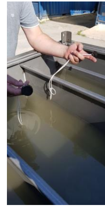
Leine ziehen und neutralisiertes Wasser ablassen.
